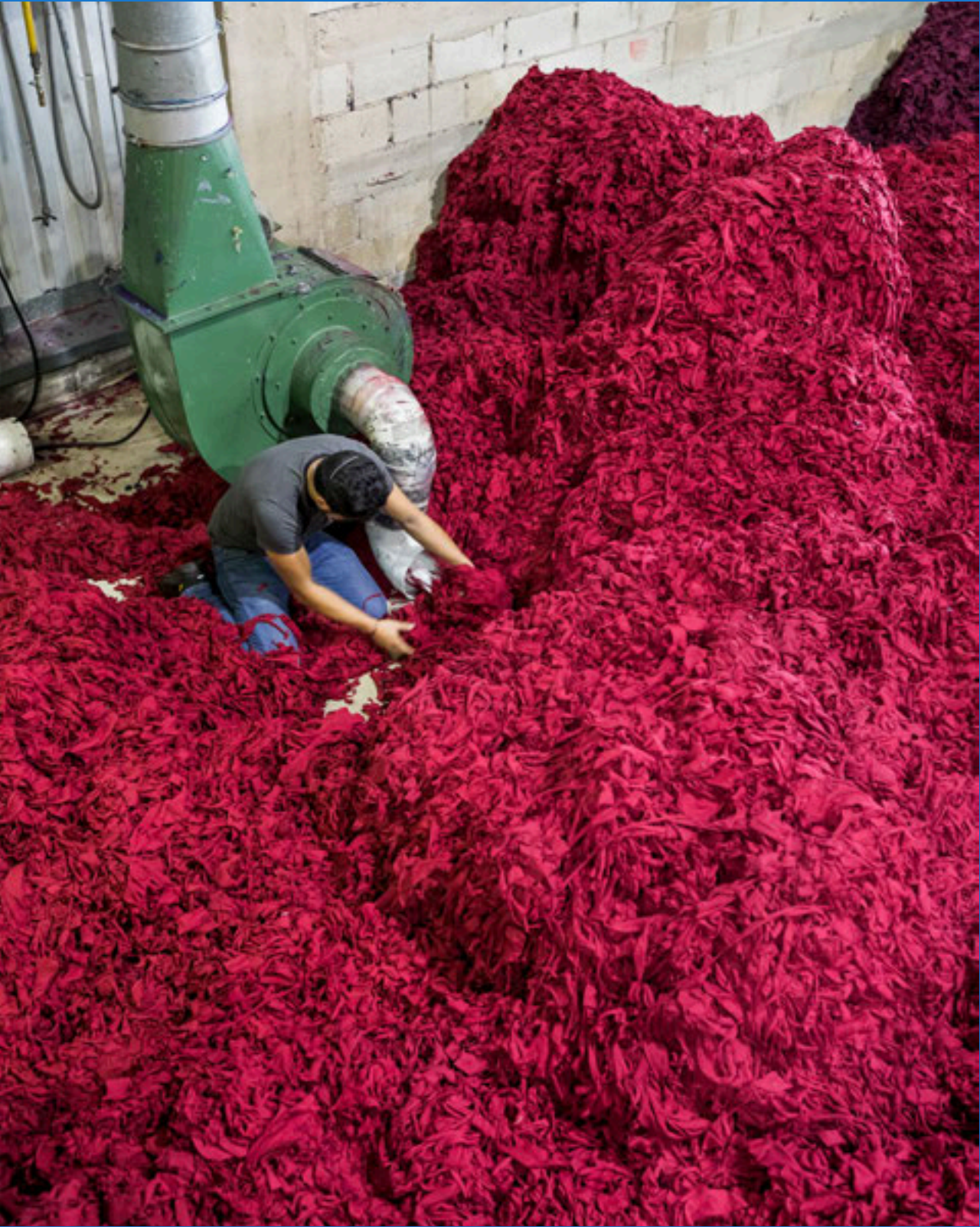
Un employé d'usine trie les retailles qui seront recyclées en fil de coton, puis transformées en vêtements Patagonia. Usine Giotex, Mérida, Mexique. Keri Oberly
